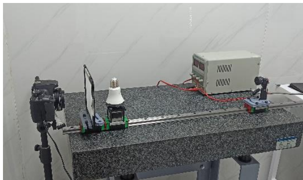
تصویر ۱: نمایی از چیدمان آزمایشگاهی سی تی اسکن با نور مرئی. از سمت راست به ترتیب منبع نور مرئی، سرپیچ لامپ روی استپر موتور، پرده و دوربین عکاسی، که همگی روی ریل قرار گرفته‌اند، را می‌توان دید.
