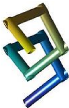
شکل ۱: شماتیکی از نانوساختار کایرال مربعی منگنز.
