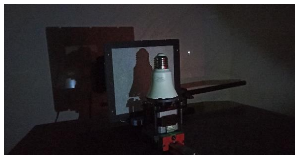
تصویر ۲: نمایی دیگر از چیدمان آزمایشگاهی سی تی اسکن با نور مرئی. سایه ناشی از سرپیچ لامپ روی پرده مشخص است. دوربین در پشت پرده تصاویر را در هر چرخش گام استپر موتور ضبط می‌کند.
