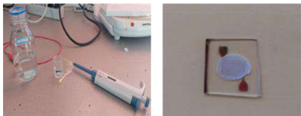
و قطعه ساخته drop casting شکل ۱: ساخت قطعه حسگری روش شده
