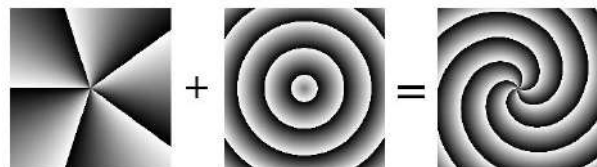
شکل ۱: توری هولوگرام فازی با پارامتر طول مشخصه r_0 = 1 سمت چپ l = 2 و سمت راست l = 5 .
