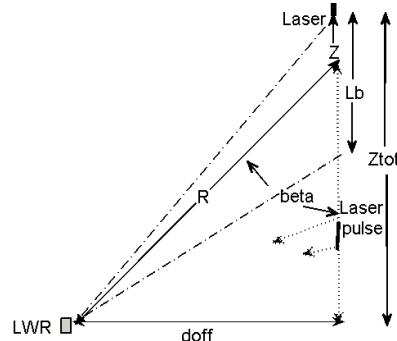
شکل ۱: نمایش موقعیت پراکندگی باریکه لیزر به وسیلهٔ ذرات معلق و آشکارسازی پرتو لیزر. فاصلهٔ خارج از محور با  $doff$  و فاصلهٔ بین نقطهٔ پراکندگی و گیرندهٔ توسط  $R$  فاصلهٔ لیزر تا گیرنده در طول محور باریکه لیزر  $Ztot$  نمایش داده شده است.
