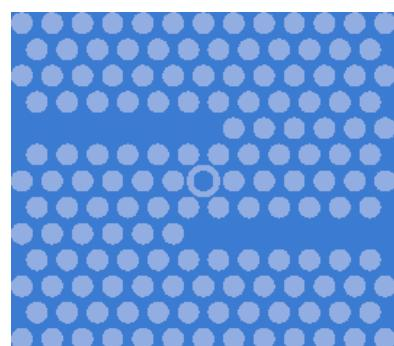
شکل ۱: ساختار حسگر فشار با  $a=440\text{ nm}$  و شعاع حفره‌های هوای  $=158/4$ ، شعاع خارجی و داخلی میکروکاواک به کارگرفته شده به ترتیب  $242\text{ nm}$  و  $148\text{ nm}$  می‌باشد.
