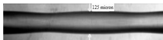
شکل ۴- یک نمونه از حسگر توری برآگ با تناب بلندر
