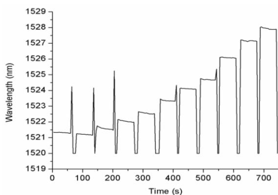
شکل ۳- تغییرات یک طول موج کمینه در طول آزمایش در شکل (۳) رفتار کمینه طول موج در زمان آزمایش مشاهده می‌شود. در این نمودار هر بخشی که به شکل یک خط صاف است نشان دهنده یک غلظت مشخص است. وقتی هر محلول برداشته می‌شود هوا اطراف حسگر را احاطه کرده و ضریب شکست به طور ناگهانی تغییر گردد که در نمودار بالا تغییرات ناگهانی نشان دهنده همین مسئله است. با توجه به نتایج به دست آمده از تکرار آزمایش‌های یک حسگر می‌توان نمودار ضریب شکست-طول موج را برای حسگرهای مختلف رسم کرد.
