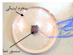
شکل ۴: نمونه پنجره اپتیکی با قطر ۱۵cm به همراه سنسور دما
