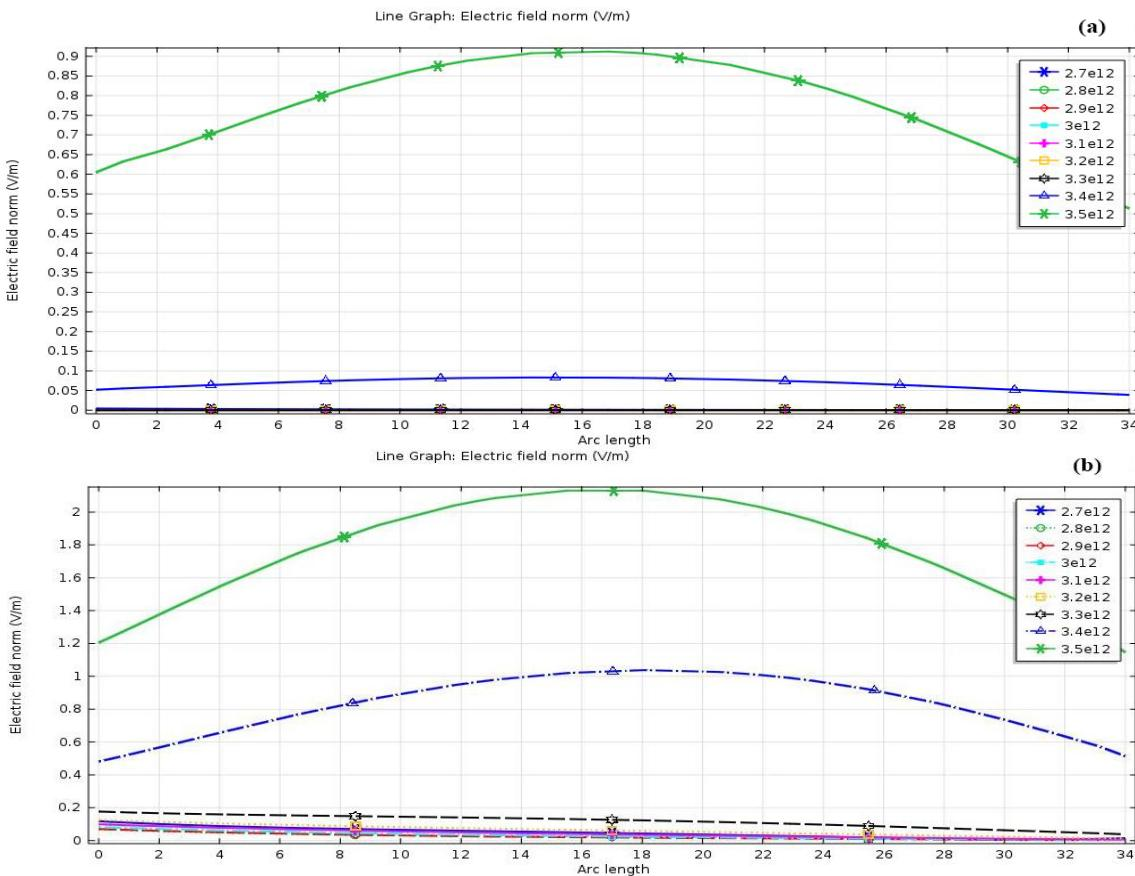
شکل ۳: نمودار a و b به ترتیب توزیع میدان الکتریکی را در پهنهای دو موجبر  $W_1$  و  $W_2$  به ازای نقص‌های  $A=6\mu\text{m}$  و  $B=8\mu\text{m}$  در نوار اول نشان می‌دهد.
