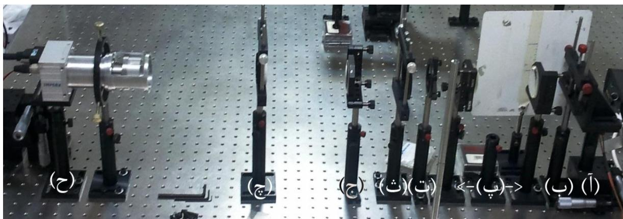
شکل ۵: چینش موازی ساز به همراه دوربین (لنز و CCD)-(آ)، (ب) گشودگی اولیه، (پ) لنزهای ۴f، (ت) گشودگی پرتوی خروجی، (ج) عدسی موازی کننده خروجی، (ج) فیلتر شدتی ND Filter و لنز قابل جابجایی.
