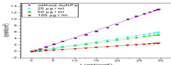
شکل ۳: توان خروجی بر حسب توان ورودی برای نمونه‌ی کنترل و نمونه‌های تیمار شده با نانوذره با غلظت‌های ۲۵، ۵۰، ۱۰۰  $\mu\text{g}/\text{ml}$ .
