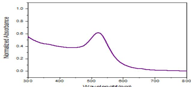
شکل ۵: طیف جذب نانوذرات کروی  $20\text{ nm}$  طلا با غلظت  $100\text{ }\mu\text{g/ml}$ .
