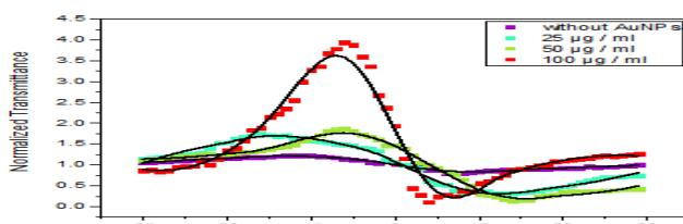
شکل ۴: نمودار جاروب محوری (زد-اسکن) دریچه بسته برای نمونه‌ی کنترل و نمونه‌های تیمار شده با نانوذره ۲۰ nm طلا در غلظت‌های ۲۵، ۵۰ و ۱۰۰  $\mu\text{g}/\text{ml}$ .
