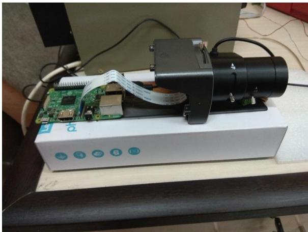
شکل ۶- دوربین بهمراه برد پردازش تصویر و اپتیک
