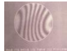
شکل ۱۵، الگوی تداخلی حاصل از آزمون MTF بر روی سله پس از انجام تنظیمات به روش
