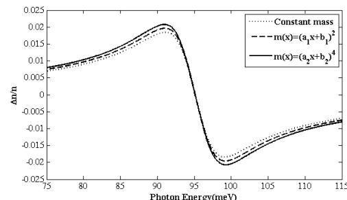
شکل ۴: تغییرات ضریب شکست کل برای جرم ثابت و دو مدل فرضی برای وابستگی جرم به مکان.
