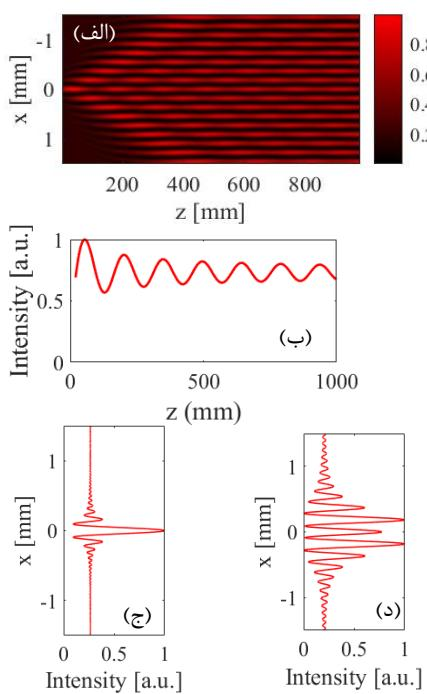
شکل ۲: (الف) توزیع شدت پراشیده از دوآینه فرنل در صفحه  $xz$  (ب) نمایه شدت پراشیده در راستای محور  $z$ ; (ج) و (د) نمایه شدت در راستای  $x$  برای  $x = 100$  mm و  $z = 20$  mm و  $z = 100$  mm
