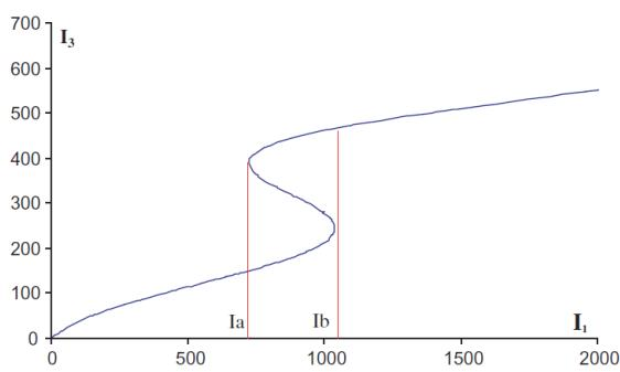
شکل ۱: شکل S در منحنی مربوط به شدتهای ورودی و خروجی در یک سیستم دوپایدار
