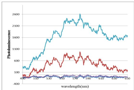
شکل ۳. طیف فوتولومینسانس سیلیکون متخلخل در ناحیه طیفی ۵۰۰-۷۰۰ نانومتر.
