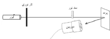
شکل ۴: نحوه‌ی قرارگیری سد نور در سر راه نور پراشیده شده از تار نوری.
