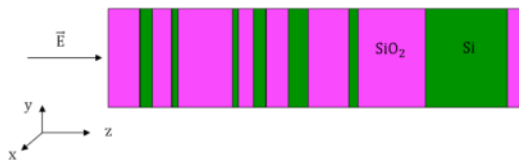
شکل ۱. طرح‌واره‌ی از یک سیستم تصادفی یک بعدی متشکل از دو لایه‌ی دی الکتریک و بهره‌ی رامان
