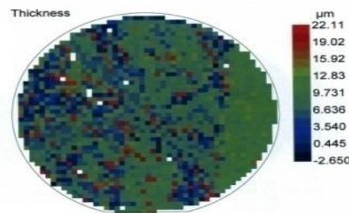
شکل ۱- تصویر و یکنواختی ضخامت ویفر GaAs
