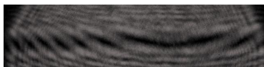
شکل ۵: جابه‌جایی فریز مرکزی پس از چرخش تیغه به اندازه ۱ درجه برای عدسی ۵۰ میلی‌متری
