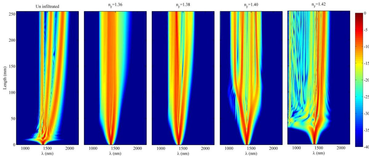
شکل ۴: نمایش تولید طیف ابرپیوستار در ۲۵۰ mm از طول فیبر برای حالت‌های مختلف شامل حالتی که سیال درون حفره‌های ردیف اول تزریق نشده و حالت‌هایی که سیال‌هایی با ضریب شکست‌های ۱۳۶، ۱۳۸، ۱۴۰، ۱۴۱ و ۱۴۲ درون حفره‌های ردیف اول تزریق شده‌اند.
