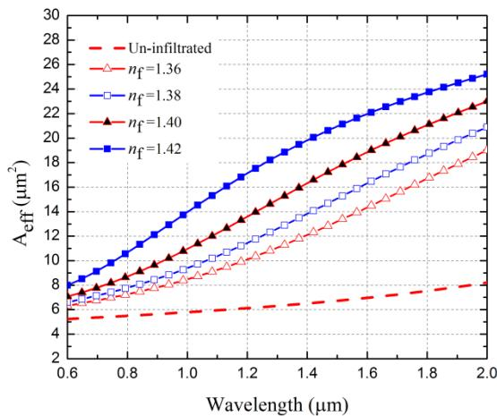
شکل ۳: مقایسه‌ی نمودار سطح مقطع موثر بر حسب طول موج برای فیبر تزریق نشده با نمودارهای مشابه برای فیبرهایی که حفره‌های مجاور هسته‌ی آن‌ها با سیال‌های گوناگون ( $1,42, 1,40, 1,38, 1,36$ ) تزریق شده‌اند.
