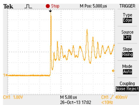
شکل ۲ : خروجی دستگاه لیزر بدون جاذب اشباع پذیر
