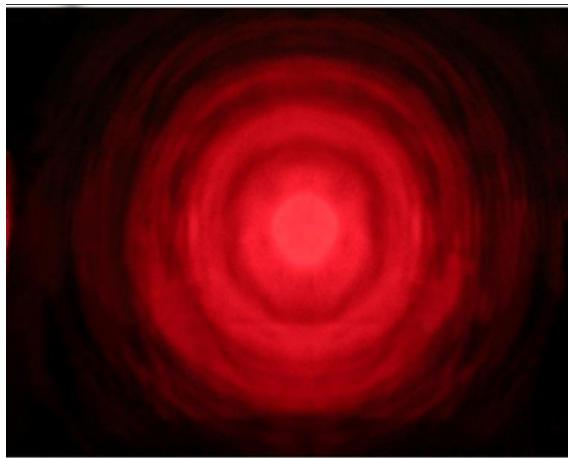
شکل ۳: حلقه‌های پراش نانوذرات  $\text{Fe}_3\text{O}_4$  در شدت  $50 \text{ mW}$  با استفاده از چیدمان پراش میدان دور
