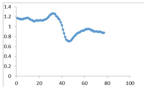
شکل ۵: منحنی جاروب-z روزنہ بسته نانو ذرات  $\text{Fe}_3\text{O}_4$
