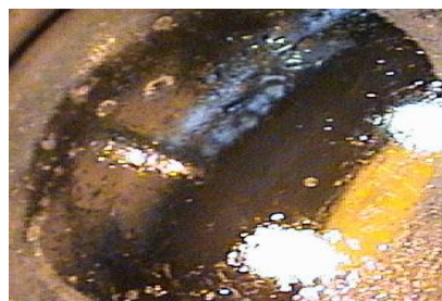
شکل ۹: تصویر پنجره اپتیکی پس از آزمون
