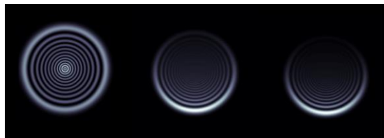
شکل ۲: الگوی شدت به ترتیب افزایش سرعت موج گرمایی در محیط از چپ به راست.
