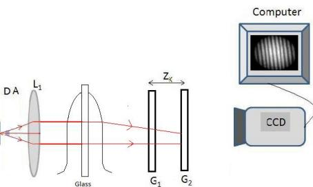
شکل ۲: طرح واره چیدمان آزمایش و اندازه‌گیری انحراف نور در هنگام خروج از فیلم مایع؛  $G_1$  و  $G_2$  توری‌های رانکی هستند که نور پس از عبور از فیلم مایع منحرف شده و طرح ماره در محل توری دوم تشکیل می‌شود.
