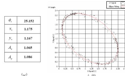
شکل ۳: (الف) نمونه‌ای از بیضی حاصل از سیگنال خروجی MI و نمایش بیضی درون یابی شده بر اساس داده‌های تجربی (ب) جدول مقادیر محاسبه شده برای پارامترهای بیضی درون یابی شده.
