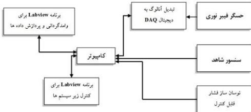
شکل ۲: نمایش شماتیک از اجزای مختلف سخت افزایی و نرم افزاری حسگر.
