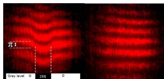
شکل (۵) الگوی تداخلی: در شکل سمت چپ با تغییر سطح سلول در قسمتی از نمایه فرانز ها جابه‌جا می‌شوند.
