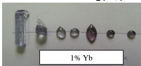
شکل ۳: نمونه های شیشه ای ساخته شده با ۱٪ مولی ناخالصی Yb.
