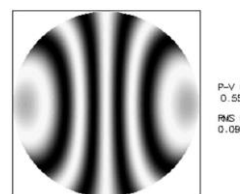
شکل ۹: الگوی تداخلی بیانگر افت کیفیت در سامانه، در نتیجه‌ی ایجاد عدم هم‌راستایی به میزان TLB=0,1^\circ در لنز اول
