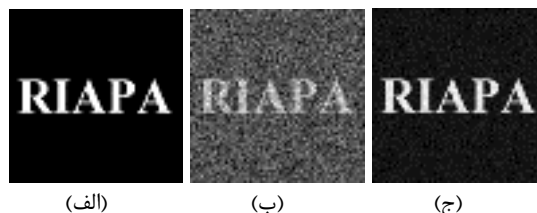
شکل ۲: تصاویر حاصل از شبیه‌سازی عددی. الف) تصویر اصلی. ب) تصویر گوست به روش محاسباتی مرسوم. ج) تصویر گوست به روش گزینشی.
