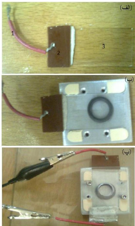
شکل ۲ : الف ) صفحه خازن به کار رفته در چیدمان : سیم رسانا (۱) . فلز رسانای متصل به سیم هادی جریان الکتریکی (۲)، لامل با لایه-نشانی ITO (۳) . ب) صفحه پایینی خازن به کار رفته که بر روی پایه پایینی محافظه نگهدارنده قرار گرفته است. واشر پلاستیکی که چمبر بوده بر روی آن قرار گرفته و محلول داخلش ریخته می‌شود. پ) چamber قرار گرفته بین صفحات خازن که در محافظه نگهدارنده محکم شده و به منبع ولتاژ وصل شده است.
