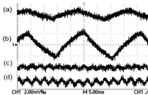
شکل ۴: سوئیچ اپتیکی DR1 در فرکانس ۵۰Hz : (a) توسط تک پرتو خطی پمپ (9 mw), (b) توسط دوپرتو خطی (9 mw) - پرتو دایروی (4.9 mw).
