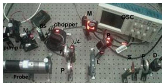
شکل ۲: P: پلاریزور، L: لنز، M: آینه، S: نمونه، F: فیلتر سیز، PD: آشکارساز، BS: اسیلوسکوپ، OSC: شکافنده پرتو.
