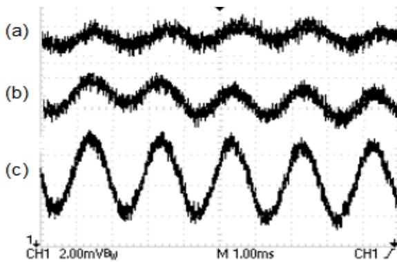
شکل ۵: سوئیچ اپتیکی DR1 در فرکانس ۵۰۰Hz : (a) توسط تک پرتو خطی پمپ، (b) (9 mw) توسط دوپرتو خطی (9 mw)- (9 mw) (c) توسط دو پرتو پمپ با قطبش عمود بر هم (9 mw, 3.3 mw).
