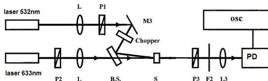
شکل ۱: چیدمان دوشکستی القایی: Ps: پلاریزور، Ls: لنز، Ms: آیه، F: فیلترساز، PD: اسیلوسکوپ، BS: شکافنده پرتو.
