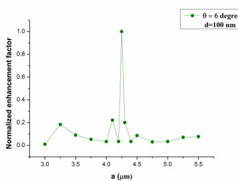
شکل ۲: فاکتور تقویت میدان الکتریکی بر حسب ابعاد دهانه‌ی ورودی ساختار
