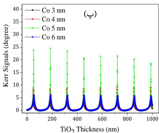
شکل ۲: سیگنال کر به ازای ضخامت‌های ۳، ۴، ۵ و ۶ نانومتر از لایه کیالت و ضخامت‌های متغیر از لایه‌های میانی مختلف (الف)  $\text{SnO}_2$ ، (ب)  $\text{SiO}_2$ ، (پ)  $\text{TiO}_2$  در ساختار Glass|Cu|Spacer layer|Co.
