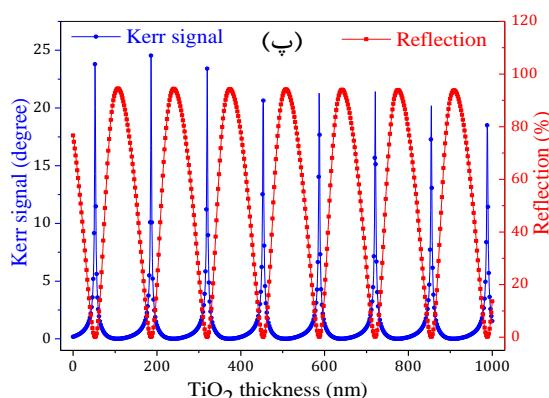
شکل (۳): سیگنال کر و درصد بازتاب در ضخامت بهینه کبالت ضخامت‌های مختلف از لایه‌های میانی (الف)  $\text{SnO}_2$  (ب)  $\text{SiO}_2$  (پ)  $\text{TiO}_2$  در ساختار Glass|Cu|Spacer layer|Co در شکل (۳) سیگنال کر و درصد بازتاب نور از ساختار برای ضخامت‌های مختلف از لایه میانی و بهینه ضخامت جدول ۲: سیگنال کر بدون حضور لایه میانی، بیشینه سیگنال کر به ازای لایه‌های میانی مختلف و ضخامت بهینه لایه میانی.
