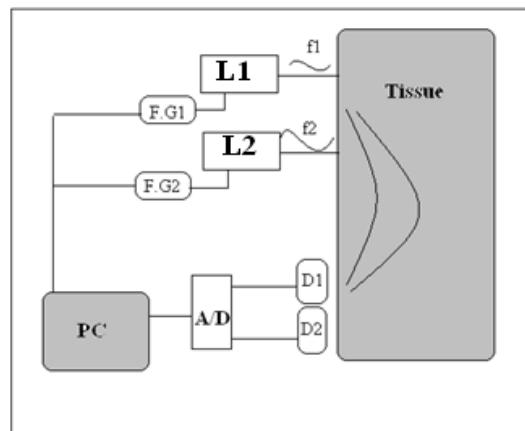
شکل ۱: شماتیکی از سامانه FNIRS که توسط دو لیزر L1 و L2 بافت را نورده می‌کند. نور توسط دو آشکارساز D1 و D2 ثبت و اطلاعات به رایانه ارسال می‌شود. F.G.1 و F.G.2 به ترتیب دو فانکشن ژنراتور برای تولید نور مدولاسیون شدتی هستند.
