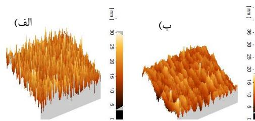
شکل ۵- زبری سطح لایه کروم با ۲۷۰ ثانیه زمان لایه‌نشانی (الف) بر روی شیشه (ب) بر روی گالیم آرسناید
