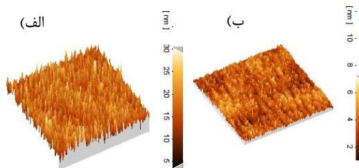
شکل ۴- زبری سطح لایه کروم با ۱۸۰ ثانیه زمان لایه‌نشانی (الف) بر روی شیشه (ب) بر روی گالیم آرسناید
