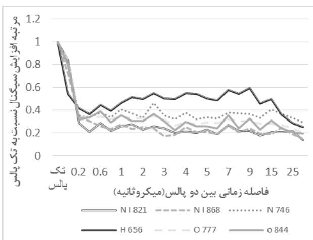
شکل ۶: تاثیر فاصله زمانی دو پالس لیزر بر افزایش شدت تابش پلاسمای برای خطوط طیفی عناصر هوا
