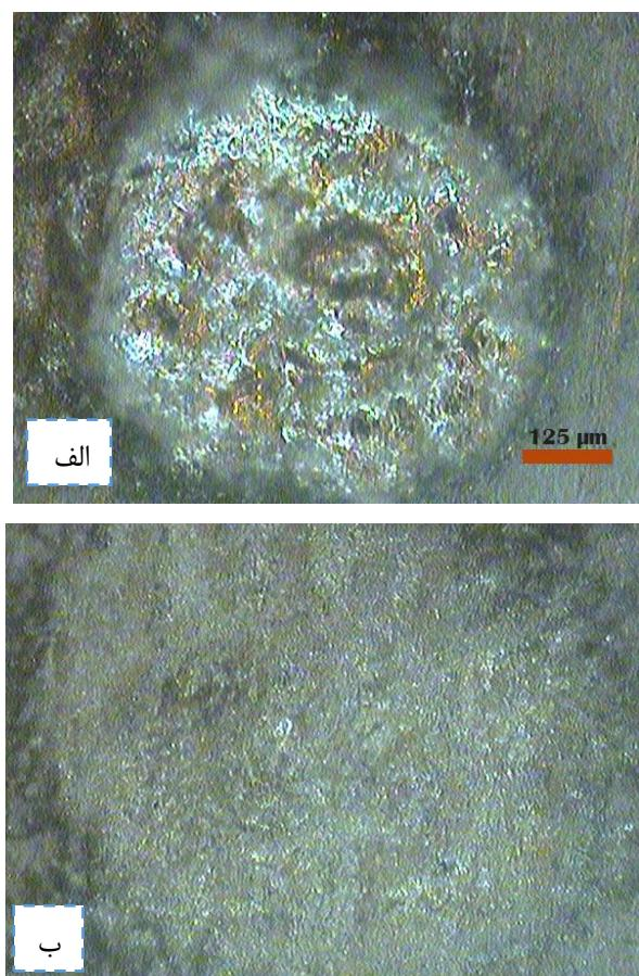
شکل ۳: مقایسه کیفی کندگی برای حالت (الف) دوپالسی (ب) تک پالس برای نمونه آلومنیوم(حالت موازی)
