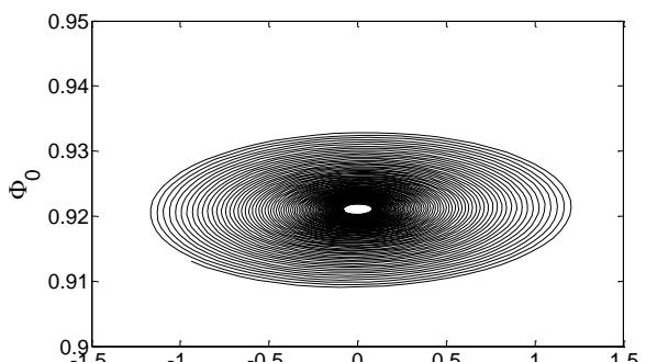
شکل ۲: نمودار فاز شدت خروجی لیزر،  $|E|^2$ ،  $\alpha = 3.3$ ،  $P = 0.42$ ،  $R = 2 \times 10^{-4}$
