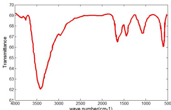
شکل ۲: الگوی طیفسنجی FTIR نمونه فریت روی
