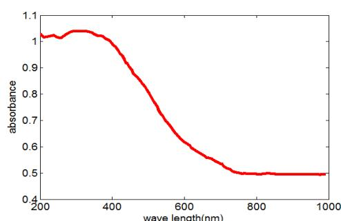
شکل ۴: الگوی طیف UV-Vis فریت روی گاف انرژی نانوذرات فریت روی با استفاده از رابطه ۴ محاسبه می‌شود. در این رابطه  $\alpha$  ضریب جذب است.
