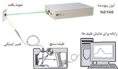
شکل ۱: طرحواره‌ای از سیستم آزمایشگاهی انجام طیفسنجی به روشناسی‌سازنی القایی لیزری بر روی بافت سالم و سرطانی.
