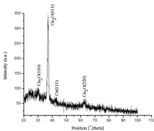
شکل ۴: طرح پراش XRD نمونه نهشت شده با توان ۳۴۰ وات.
