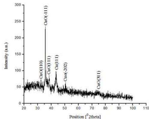
شکل ۳: طرح پراش XRD نمونه نهشت شده با توان ۳۱۰ وات.
