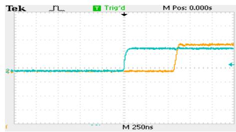
شکل ۸: تاخیر زمانی کل سامانه برابر ۵۷۵ نانو ثانیه. سیگنال آبی: سیگنال فرمان به فرستنده و سیگنال نارنجی: سیگنال خروجی گیرنده بعد از گیت زمانی (این میزان مستقل از اندازه کاراکترها است)
