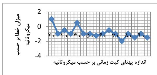
شکل ۵: تغییر اندازه پهنهای دروازه زمانی در محدوده ۲۰ تا ۹۵ میکروثانیه برای رمزگشایی قطار پالس شامل ۴ پالس با دوره تناوب ۰/۰۵ ثانیه و تاخیر زمانی برابر ۱۵ میکروثانیه
