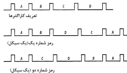
شکل ۲: سری رمزهای تولیدی برای لیزر بر اساس کاراکترهای رمز
