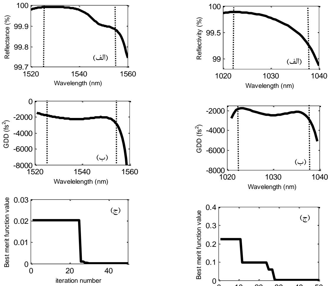
شکل ۲: نتایج بدست آمده برای بهترین ذره برای نوسان ساز Cr:YAG حول ۱۵۴۰ نانومتر: (الف) بازتابش، (ب) پاشندگی تأخیرگروه، و (ج)تابع شایستگی بهترین ذره بر حسب تعداد تکرار.
