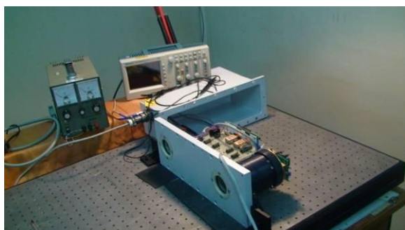
شکل (۷): نمائی از فاصله یاب ساخته شده
