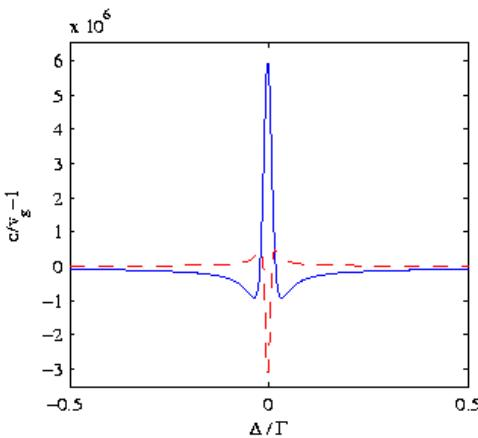
شکل ۵: ضریب گروه بر حسب  $\Delta/\Gamma$ . منحنی توپر (خطه چین) برای  $R=0.5\Gamma$  ( $1.5\Gamma$ ). بقیه پارامترها مانند شکل ۲(a) است.
