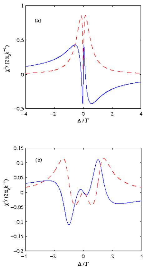
شکل ۲: پاشندگی (منحنی توپر) و جذب (منحنی خط چین) بر حسب  $\Delta/\Gamma$  برای پارامترهای  $\Omega_c = 0.0$ ,  $\Gamma_d = 0.5\Gamma$ ,  $\Gamma = 1$
