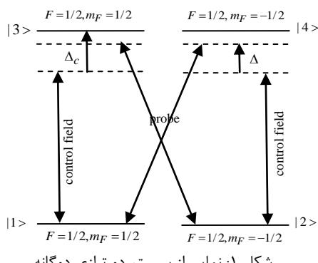
شکل ۱: نمایی از سیستم دو ترازی دو گانه
