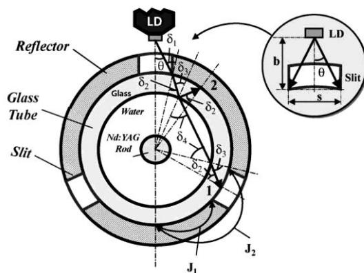
شکل ۲: نمایی از نحوه ورود و شکست پرتو در محفظه دمش [۲]. توان LD جذب شده توسط میله لیزری به صورت زیر محاسبه می‌شود [۲]:
