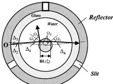
شکل ۳: انتشار پرتو درون محفظه پخش کننده برای یک منبع نور ایجاد شده روی دیواره داخلی بازتابنده [۲].
