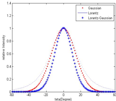
شکل ۱: توزیع شدت میدان گاوسی، لورنتس و لورنتس-گاوسی
