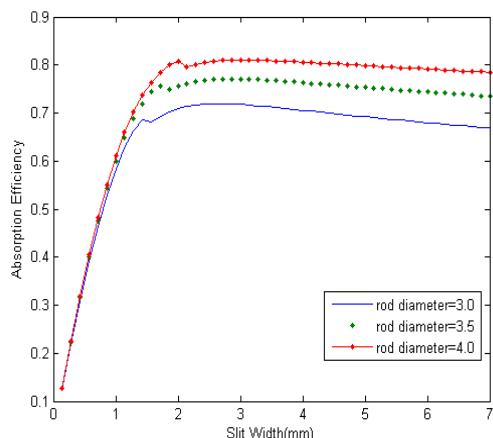
شکل ۶: بازده جذب یک لیزر Nd:YAG دایود دمش بر حسب پهنهای شکاف برای  $\phi$  های مختلف و شکل پروفایل لورنتس-گاووس به ازای  $d = 1.5\text{mm}$ .
