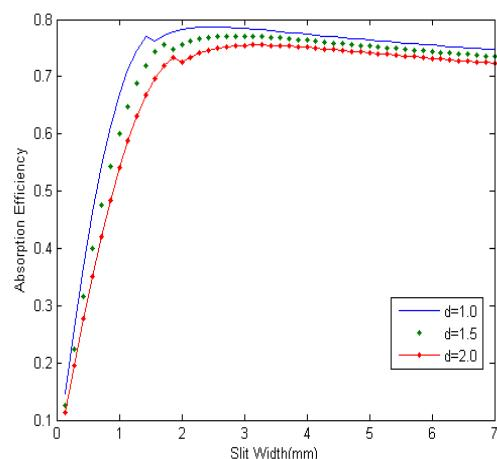
شکل ۵: بازده جذب یک لیزر Nd:YAG دایود دمش بر حسب پهنهای شکاف برای  $\phi$  های مختلف و شکل پروفایل لورنتس-گاووس به ازای  $\phi = 3.5\text{mm}$ .
