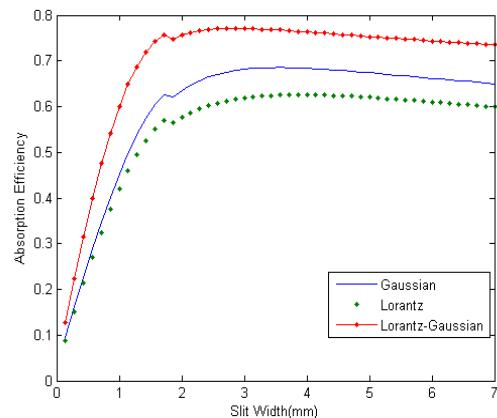
شکل ۴: بازده جذب یک لیزر Nd:YAG دایود دمش بر حسب پهنهای شکاف برای شکل میدانهای مختلف به ازای  $\phi = 3.5\text{mm}$ ،  $d = 1.5\text{mm}$ .
