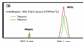
شکل ۳. دو خط مشخصه تابشی، برای دو فلز جوش در پهنای پالس متفاوت ۳ و ۵msec و چگالی توان تابشی ۱۵GW/m²
