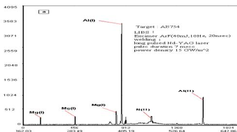
شکل ۲. نمونه‌ای از طیف بدست آمده از آنالیز LIBS بر روی نمونه فلز جوش در شرایط جوشکاری با پهنای پالس ۷msec و چگالی تابشی ۱۵GW/m<sup>2</sup> در شکل ۳ دو خط مشخصه تابشی، برای دو فلز جوش در شرایط جوشکاری مختلف با هم مقایسه شده است. هر دو نمونه در چگالی تابشی ۱۵GW/m<sup>2</sup> و در دو پهنای پالسی متفاوت ۳ و ۵msec تابش دهی شده است. همانطور که از شکل نتیجه می‌شود، نسبت شدت آلومینیم به منیزیم در طیف سنجی از فلز جوش، جوشکاری شده در پهنای پالسی ۳msec، کوچکتر از این نسبت، در طیف
