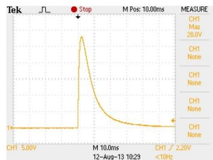
شکل ۶- تصویر مشاهده شده از عملکرد لیزر در فرکانس ۱ هرتز با انرژی ۴/۱ جول توسط اسیلوسکوپ
