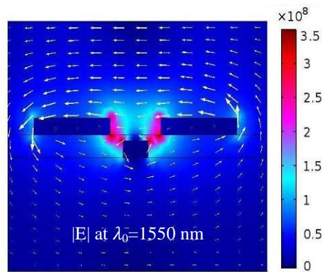
شکل ۲: (الف) اندازه میدان الکتریکی  $|E|$  در مد اصلی موجبر سیلیکونی QCPW در طول موج  $\lambda_0=1550 \text{ nm}$ . پیکان‌ها میدان مغناطیسی را نشان می‌دهند.
