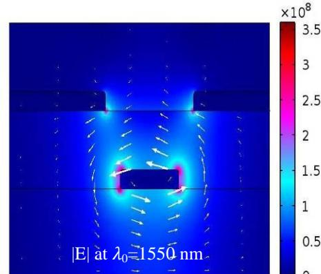
شکل ۳: پروفایل اندازه میدان الکتریکی  $|E|$  در مد اصلی موجبر فلزی QCPW در طول موج  $\lambda_0=1550 \text{ nm}$ . پیکان‌ها میدان مغناطیسی را نشان می‌دهند.
